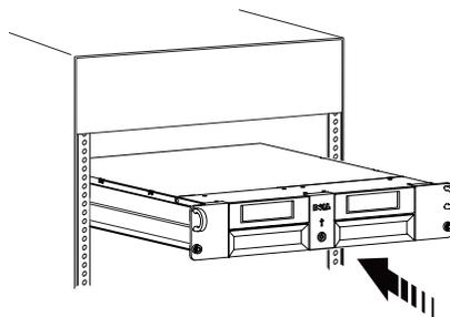
Abbildung 3-2. Laufwerk für den Rackeinbau einschalten
