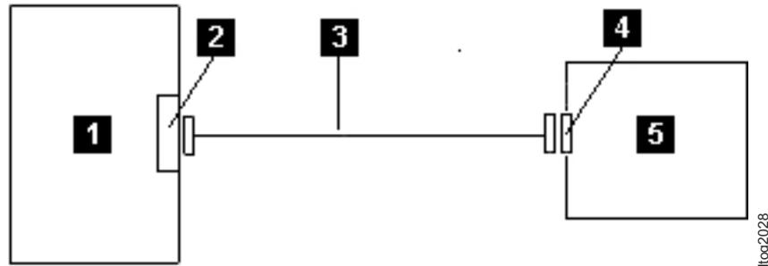
Abbildung 2-6. SAS-Kabel anschließen
