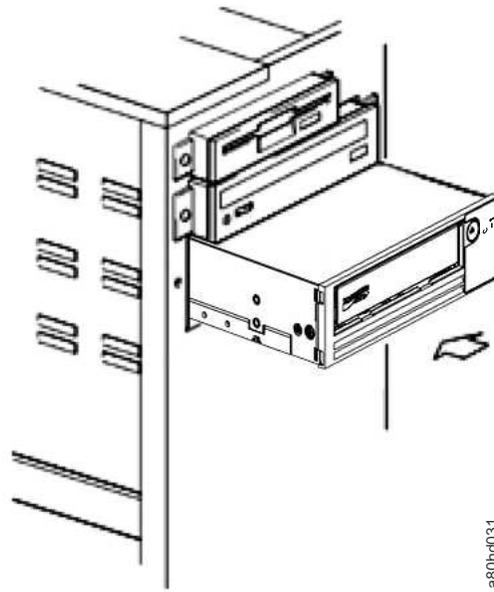
Abbildung 2-2. Laufwerk installieren
