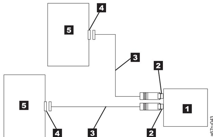
Abbildung 2-7. Zwei SAS-Hosts an ein Bandlaufwerk anschließen
