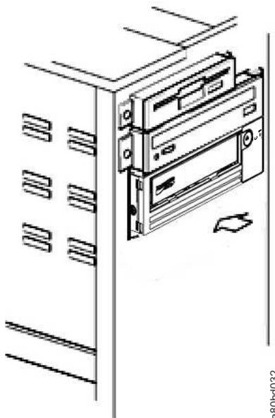
Abbildung 2-5. Laufwerk befestigen
