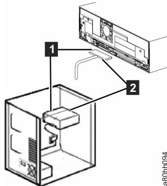
Abbildung 2-4. SAS-Kabel anschließen
