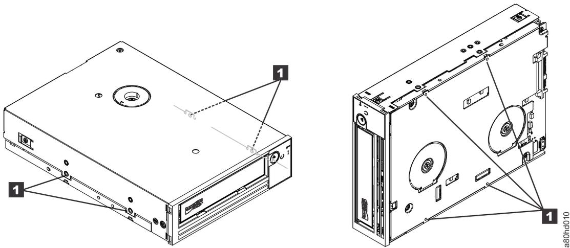
Abbildung 2-3. Befestigungslöcher am Bandlaufwerk
